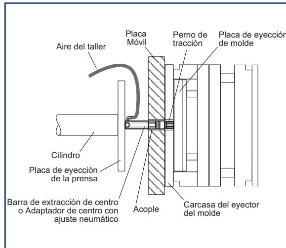
Para prensas pequeñas con extracción central, reemplace el perno del cilindro (si corresponde) con una barra de extracción central y un acople FasTie.
