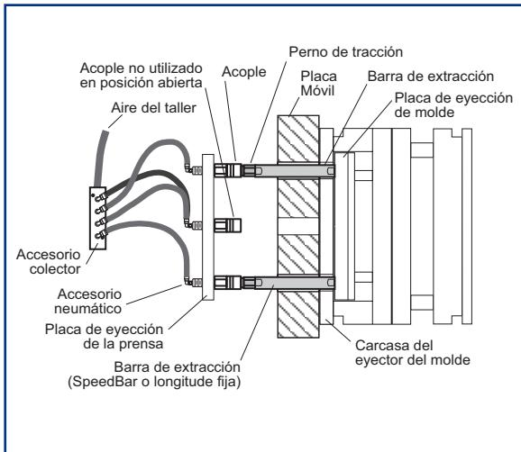
Esta configuración está diseñada para moldeadores personalizados que utilizan una variedad de moldes de inyección con diferentes patrones de extracción y movimientos de eyección.
