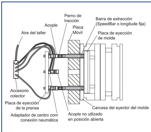
Esta configuración se utiliza cuando existe acceso limitado a la parte posterior de la placa de eyección de la prensa. Los moldeadores personalizados que utilizan prensas más pequeñas se verán beneficiados con esta aplicación.
